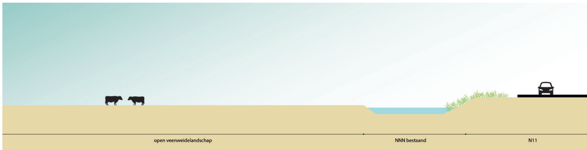
Principedoorsnede 4: bestaande situatie, open weidelandschap, brede watergang, N11 op grondlichaam circa 1m boven maaiveld.
